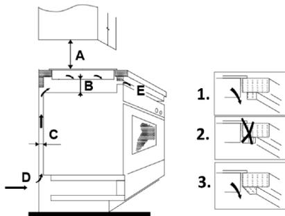
**D = BELÜFTUNGSSCHLITZ / E = LUFTAUSLASS**
