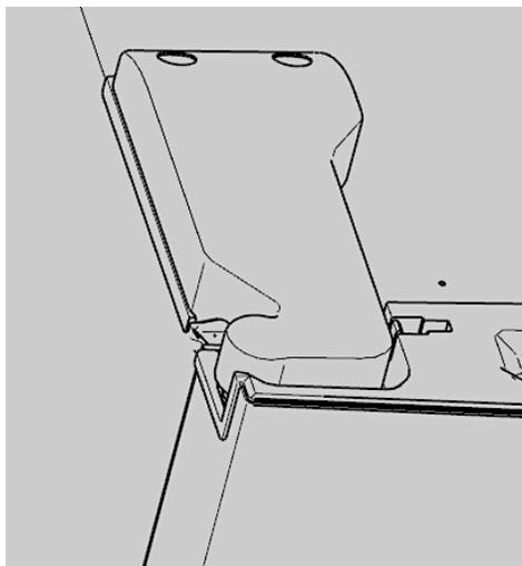
21. Installieren Sie den Türmagneten (s. Schritt 7.) auf der linken Seite der Tür.
