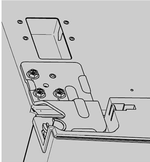
20. Installieren Sie die linke obere Türscharnierabdeckung.
