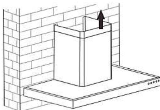
4. Wenn Sie die gewünschte Höhe erreicht haben, hängen Sie die Befestigungslöcher in die Befestigungsschrauben, wie unten dargestellt.
