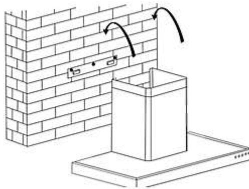
3. Setzen Sie den oberen Kamin in den unteren Kamin ein. Ziehen Sie den oberen Kamin nach oben aus. Richten Sie den Kamin entsprechend seiner gewünschten Höhe aus.
