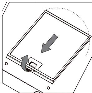
3. Stecken Sie den Kohlefilter auf das Gerät und drehen Sie ihn im Uhrzeigersinn.
