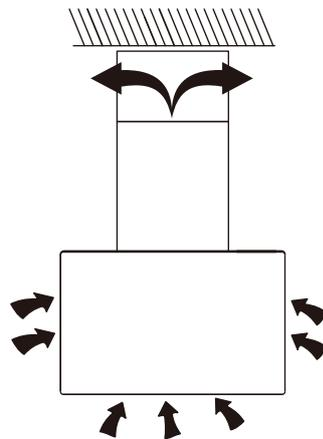
2. Sie können nur beim Umluftbetrieb Kohlefilter zur Geruchsbindung verwenden. Entnehmen Sie zur Installation der Kohlefilter zuerst den Fettfilter. Drücken Sie hierzu auf den Verschluss und ziehen Sie dann den Fettfilter nach unten.
