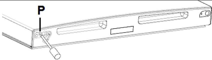
**P** | TÜRBLOCK AUF DER LINKEN UNTERSEITE DER KÜHLSCHRANK-
