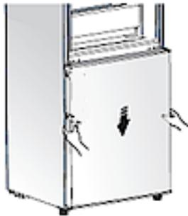
28. Richten Sie das mittlere Türscharnier (J) ordnungsgemäß an den vorbereiteten Löchern auf der linken Seite des Gerätes aus; s. Abb. unten (möglicherweise müssen Sie das mittlere Scharnier um 180° drehen, um es an den vorbereiteten Löchern auszurichten -modellabhängig-). Setzen Sie dabei den Scharnierbolzen des mittleren Türscharniers vorsichtig in die obere Scharnieröffnung der Gefrierschranktür ein und schrauben Sie dann das Scharnier fest.
