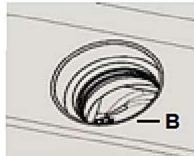
4. Bringen Sie den Wassertank wieder in der Tür an: Achten Sie darauf, dass der Dichtungsring ordnungsgemäß eingesetzt ist. Halten Sie beide Seiten des Wassertanks gut fest, setzen Sie das Wasserventil in die dafür vorgesehene Öffnung ein und bringen Sie den Wassertank in einem 45° Winkel an.
