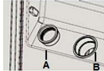
c) Setzen Sie den Dichtungsring wieder ordnungsgemäß in die Öffnung (B) ein.
