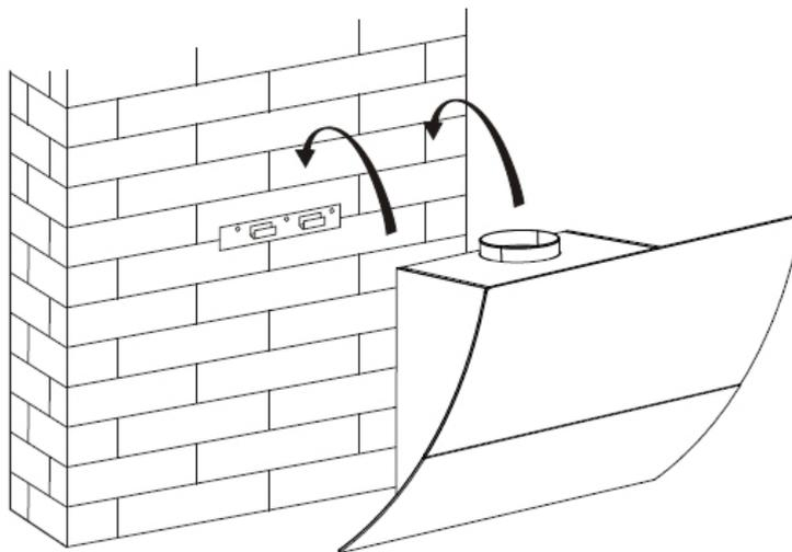
3. Sie benötigen zusätzlich vier 8 mm Bohrungen, um das Gerät mit den entsprechenden Schrauben und Dübeln zu fixieren:
