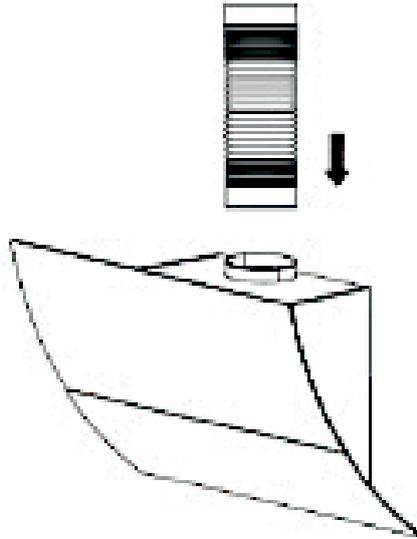
8. Setzen Sie den oberen Kamin (5) in den unteren Kamin (4) ein. Verwenden Sie zwei 4\*8 mm Schrauben, um die untere Kaminhalterung (6) in gewünschter Höhe am unteren Kamin zu befestigen (s. Abb. unten). Ziehen Sie die Schrauben nicht zu fest, damit der obere Kamin nach Montage ausziehbar bleibt.
