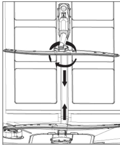
5. Um die Sprüharme wieder ordnungsgemäß einzusetzen gehen Sie bitte in umgekehrter Reihenfolge vor.
