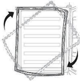
27. Befestigen Sie die Gefrierschrankschranktür an dem unteren Türscharnier. Setzen Sie dazu den Scharnierbolzen des unteren Türscharniers vorsichtig in die untere Scharnieröffnung der Gefrierschrankschranktür ein. Halten Sie die Tür in Position; s. Abb. unten.
