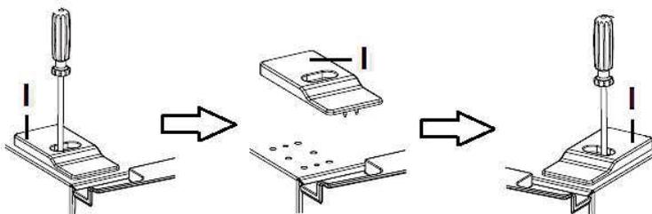
13. Heben Sie die Kühlschrankschranktür an und entnehmen Sie sie vorsichtig; s. Abb. unten. Legen Sie die Kühlschrankschranktür mit der Außenverkleidung nach oben auf eine gerade Oberfläche.
