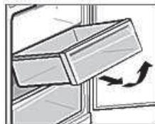
**i** Für die Reinigung können alle Gefrierschubladen auf oben gezeigte Weise entnommen **und eingesetzt werden**.<sup>8</sup>
