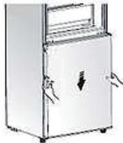
28. Richten Sie das mittlere Türscharnier (**J**) ordnungsgemäß an den vorbereiteten Löchern auf der linken Seite des Gerätes aus; s. Abb. unten (möglicherweise müssen Sie das mittlere Scharnier um  $180^\circ$  drehen, um es an den vorbereiteten Löchern auszurichten -modellabhängig-). Setzen Sie dabei den Scharnierbolzen des mittleren Türscharniers vorsichtig in die obere Scharnieröffnung der Gefrierschrankschranktür ein und schrauben Sie dann das Scharnier fest.
