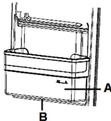
5. Drücken Sie beide Seiten des Wassertanks leicht und vorsichtig nach unten bis der Wassertank ordnungsgemäß in der Gerätetür sitzt.
