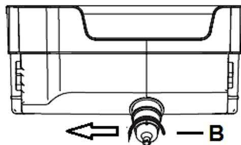
3. Um die **Abdeckung** des Wassertanks (E) vom Wassertank (A) selbst zu trennen, drücken Sie zuerst an einer Seite des Wassertanks das Verbindungsstück / den Flansch der Wassertankabdeckung leicht und vorsichtig nach oben. Dann wiederholen Sie das Prozedere auf der anderen Seite des Wassertanks. Nehmen Sie die Abdeckung vom Wassertank ab.
