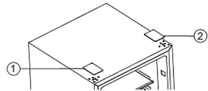
13. Bringen Sie die Tür in Einbauposition. Richten Sie Bauteil 1 und die Tür aus. Befestigen Sie dann Bauteil 1 mit den Schrauben (2). Halten Sie die obere Tür dabei fest. Installieren Sie Bauteil 3 (im Plastikbeutel). Schieben Sie Bauteil 3 zuerst komplett von links nach rechts und drücken Sie es dann nach unten.
