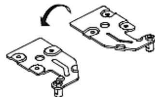
12. Entfernen Sie die linke Schraubenlochabdeckung (1) und bringen Sie die rechte Schraubenlochabdeckung (2/im Plastikbeutel) an.
