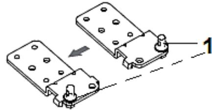
9. Versetzen Sie das untere Scharnier (1) auf die linke Seite und die Bauteile 2 und 5 auf die rechte Seite. Befestigen Sie das untere Scharnier (1) mit den Schrauben (4). Befestigen Sie abschließend Bauteil 3.
