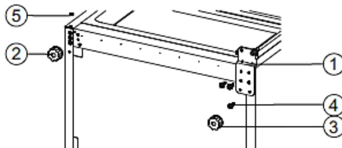
8. Schrauben Sie das untere Scharnier ab und bringen Sie die Scharnierachse (1) in der nebenliegenden Öffnung an.
