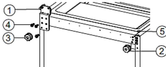
10. Nehmen Sie die untere Tür und richten Sie die Position der unteren Öffnung und der oberen Scharnierachse aus. Drehen Sie das mittlere Scharnier um 180°. Richten Sie das mittlere Scharnier auf die passende Position aus und befestigen Sie es.
