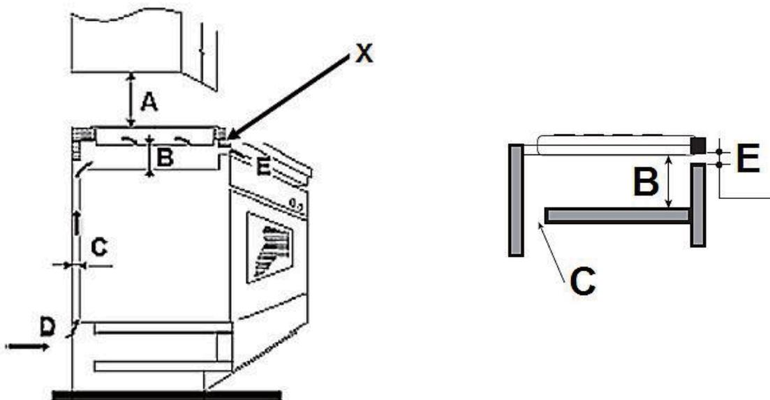
**C = BEL FTUNGSSCHLITZ / E = LUFTAUSLASS**
