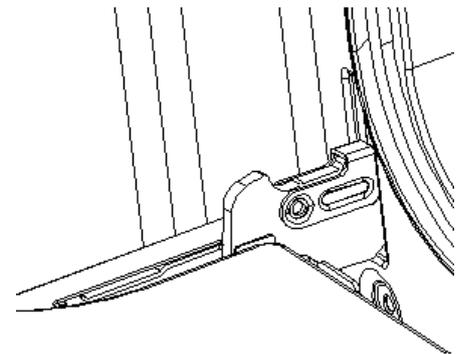
4. **Falls der Sicherheitsbügel nicht ordnungsgemäß geschlossen ist, wird das Scharnier beim Schließen der Tür beschädigt.**
