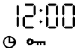
11. Sobald die Temperatur im Inneren des Backofens **weniger als 300 °C** beträgt, wird die **Türverriegelung** des Gerätes **deaktiviert**. Die Anzeige der Türverriegelung «
