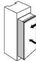
3. Schrauben Sie eine Führung mit den kleinen Schrauben in die Löchern an der Gerätetür. Schieben Sie den Gleiter in die Führung. Öffnen und schließen Sie dann die Gerätetür und die Schranktür vollständig, um zu prüfen, ob sich die Schranktür komplett und reibungslos schließen lässt.
