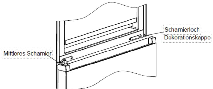
8) Setzen Sie den Kühltürkörper auf das mittlere Scharnier und montieren Sie das obere Scharnier; verbinden Sie das obere Signal 4 des Kühlschranks mit der Signalleitung 1 des Türkörpers. Schließlich wird die Scharnierabdeckung am linken Scharnier angebracht; die Zierkappe der Scharnierabdeckung wird oben auf der rechten Seite angebracht.
