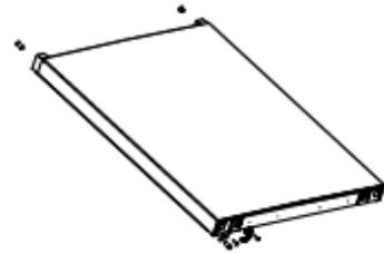
7) Montieren Sie die ausgetauschte Kühlschranksür auf das untere Scharnier, montieren Sie dann das mittlere Scharnier und decken Sie die Zierkappe für das Scharnierloch ab.
