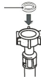
2. Befestigen Sie das **gerade** Ende des Wasserzulaufschlauchs an dem entsprechenden Wasseranschluss (s. Abb. rechts). Drehen Sie den Schlauch **per Hand** fest; verwenden Sie **keine** Zange oder ähnliche Werkzeuge.
