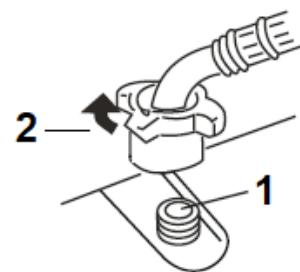
**HINWEIS!** Ziehen Sie den Wasserzulaufschlauch nicht zu stark an. Dadurch könnten die Ventile beschädigt werden.
