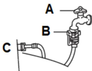
4. Lösen Sie den Wasserzulaufschlauch und tauchen Sie ihn in warmes Wasser (ca. 50 °C / s. Abb. unten).
