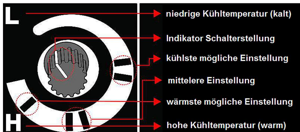
6. Lokalisierung der Einstellung hinten am Gerät.
