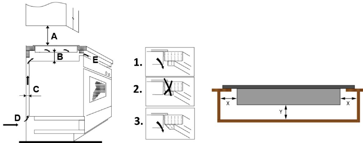
**D = BELÜFTUNGSSCHLITZ / E = LUFTAUSLASS**
