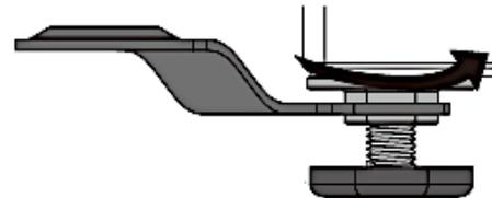
3. Drehen Sie zur waagerechten Ausrichtung des Gerätes die verstellbaren Standfüße.
