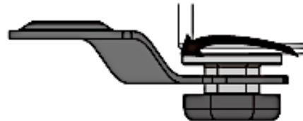
b. **Festziehen** der Kontermutter: mit dem Schraubenschlüssel **nach rechts** drehen (s. Abb. rechts).
