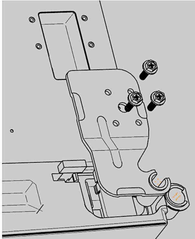
8. Setzen Sie das Türkommunikationskabel in die Öffnung an der Tür ein und installieren Sie die Abdeckung.
