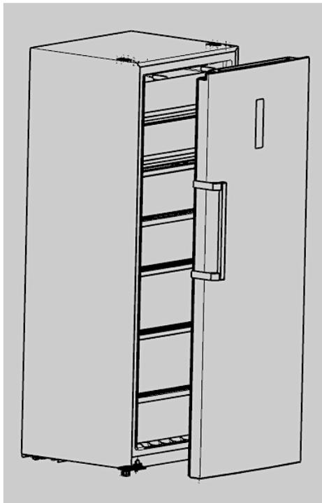
11. Es ist notwendig, dass das Gerät nach hinten gekippt wird. Lehnen Sie das Gerät dabei gegen eine feste und unverrückbare Fläche, damit es nicht wegrutschen kann. Kippen Sie das Gerät **nicht** über einen Winkel von 45° hinaus.
