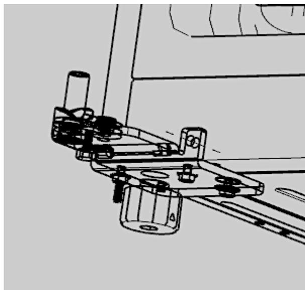
14. Schrauben Sie den **rechten** Türblock auf der **Unterseite der Gerätetür** ab und verwahren Sie ihn an einem sicheren Ort. Entnehmen Sie dem Zubehörbeutel den **linken Türblock** und installieren Sie ihn entsprechend auf der linken Unterseite der Gerätetür.
