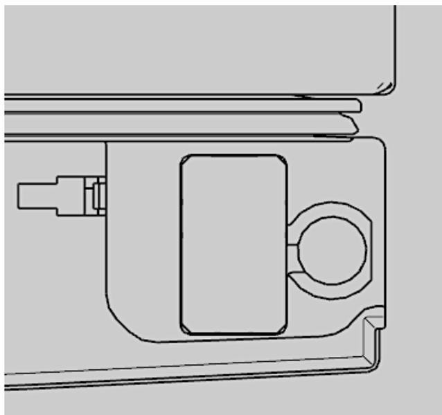
9. Entfernen Sie die obere Schraubenlochabdeckung auf der linken Seite der Tür. Schrauben Sie die linke Abdeckung ab und entnehmen Sie sie. Nehmen Sie den Kabelstrang aus der Öffnung und installieren Sie die Türmanschette (s. Schritt 7.).
