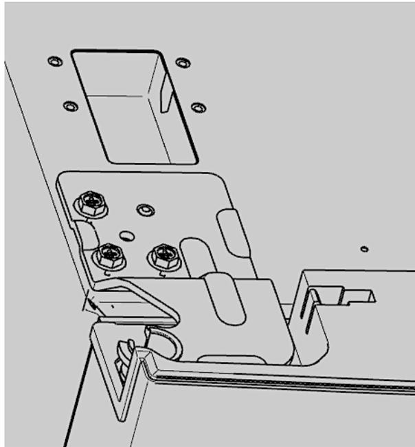
20. Installieren Sie die linke obere Türscharnierabdeckung.
