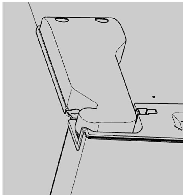
21. Installieren Sie den Türmagneten (s. Schritt 7.) auf der linken Seite der Tür.
