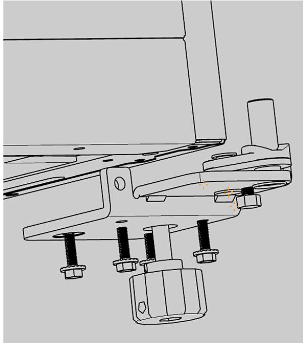
13. Entnehmen Sie dem Zubehörbeutel das **linke untere Türscharnier**. Richten Sie das Türscharnier ordnungsgemäß an den Löchern auf der **linken** unteren Seite des Gerätes aus und schrauben sie es fest. Installieren Sie die verstellbaren Standfüße wieder.
