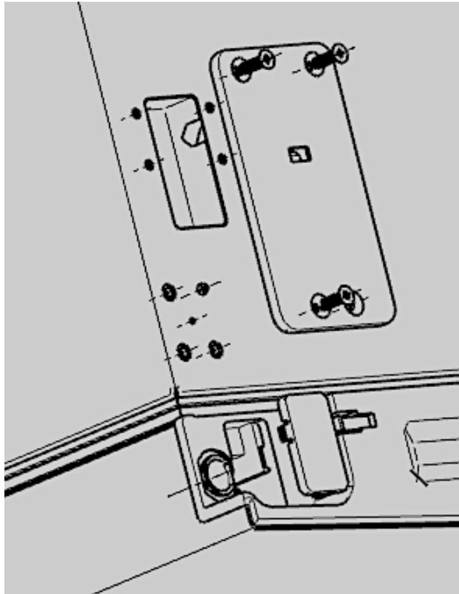
10. Heben Sie die Tür des Gerätes an und entnehmen Sie sie vorsichtig. Legen Sie die Tür mit der **Außenverkleidung nach oben** auf eine gerade Oberfläche.
