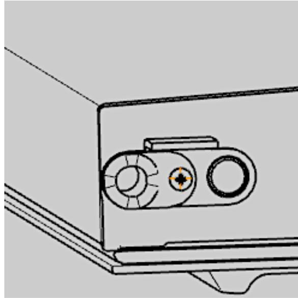
15. Entnehmen Sie dem Zubehörbeutel das **linke obere Türscharnier** und die **linke obere Türscharnierabdeckung**.
