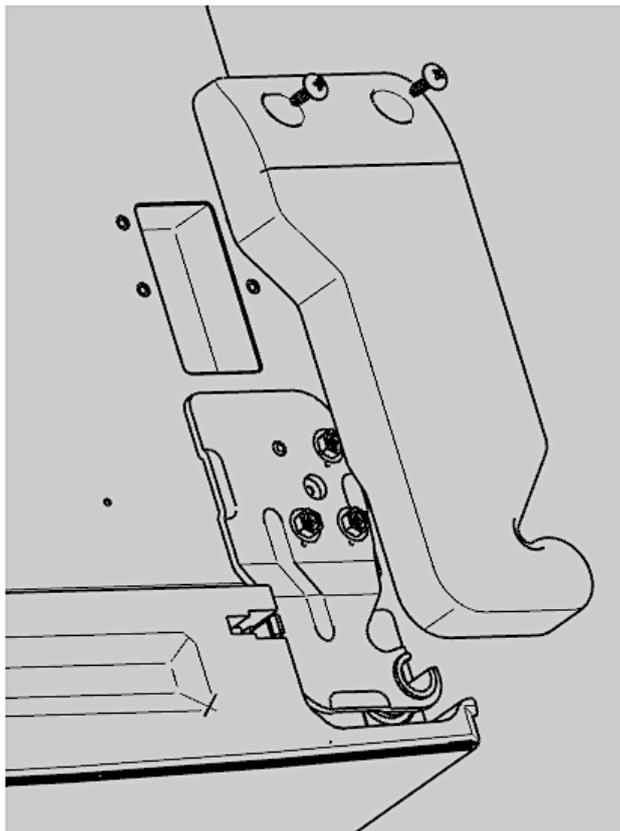
6. Schrauben Sie das rechte obere Türscharnier ab und entnehmen Sie es. Verwahren Sie die rechte obere Türscharnierabdeckung und das rechte obere Türscharnier an einem sicheren Ort.
