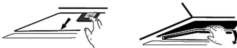
3. Stecken Sie den Kohlefilter auf das Gerät und drehen Sie ihn im Uhrzeigersinn.
