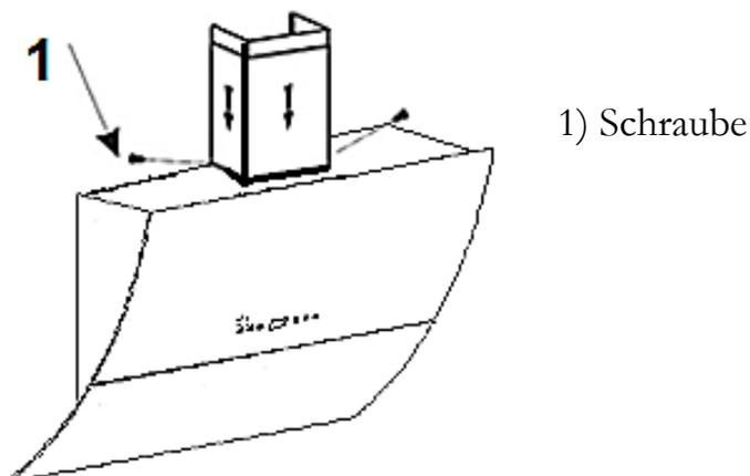
2. Lassen Sie den Kamin gleiten bis Sie die erforderliche Höhe erreicht haben. Befestigen Sie dann wie unten dargestellt das Halteeisen 1 mit 2 Stück 4\*8 mm Schrauben.
