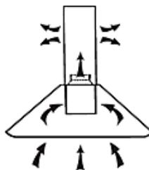
2. Sie können nur beim Umluftbetrieb Kohlefilter zur Geruchsbindung verwenden. Entnehmen Sie zur Installation der Kohlefilter zuerst den Fettfilter. Drücken Sie hierzu auf den Verschluss und ziehen Sie dann den Fettfilter nach unten.
