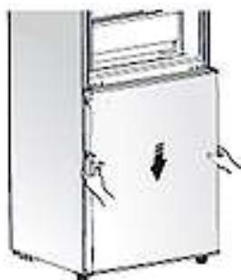
28. Richten Sie das mittlere Türscharnier (J) ordnungsgemäß an den vorbereiteten Löchern auf der linken Seite des Gerätes aus; s. Abb. unten (möglicherweise müssen Sie das mittlere Scharnier um  $180^0$  drehen, um es an den vorbereiteten Löchern auszurichten -modellabhängig-). Setzen Sie dabei den Scharnierbolzen des mittleren Türscharniers vorsichtig in die obere Scharnieröffnung der Gefrierschranktür ein und schrauben Sie dann das Scharnier fest.
