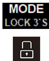
2. Drücken Sie die Taste « **MODE / LOCK 3'S** » wiederholt, bis die **Betriebsanzeige** des **URLAUBSMODUS** blinkt.
