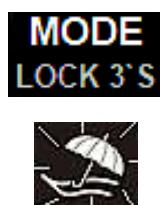
3. Nach 5 Sekunden, **ohne** weitere Betätigung der Bedientasten, wird der **URLAUBSMODUS aktiviert** und die Betriebsanzeige leuchtet dauerhaft.
