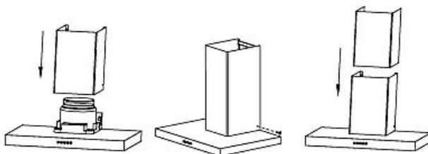
6. Richten Sie die Kaminteile entsprechend der Abmessungen des Haltebügels aus.
