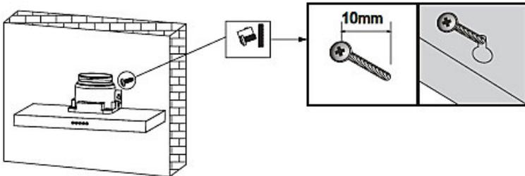
3. Ziehen Sie die vier Schrauben fest. Beginnen Sie mit den oberen beiden Schrauben und ziehen Sie danach die unteren fest.
