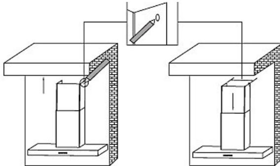
7. Befestigen Sie den Haltebügel an der entsprechenden Stelle an der Wand.
