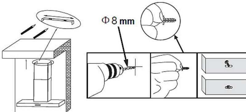
8. Befestigen Sie den oberen Kamin mit 4\*10 Schrauben am Haltebügel.
