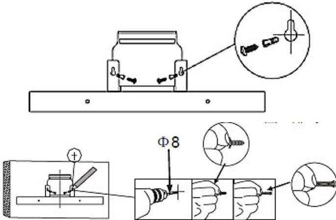
2. Hängen Sie die Haube auf, indem Sie die zwei Installationsöffnungen auf die zwei Schrauben setzen. Richten Sie die Haube aus.
